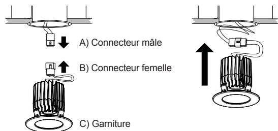
Pour les garnitures dirigeables (LD2A, LD2B, LD2D, LD2E, LD3A, LD3B, INT20PA, INT21PA), choisir l'angle d'inclinaison, resserrer les vis afin de verrouiller en position.
