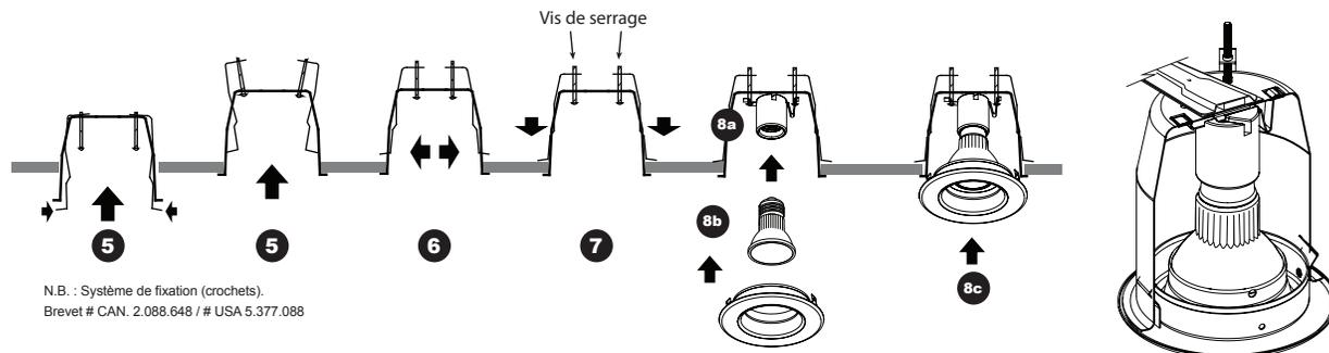
N.B. : Système de fixation (crochets).
