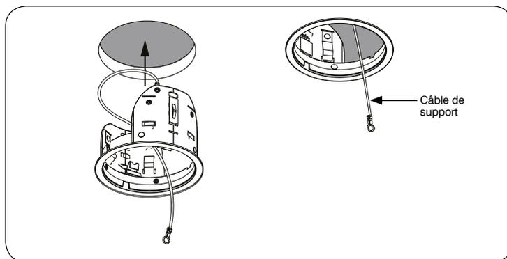
**IMPORTANT :** Les supports de garniture, qu'ils soient ronds ou carrés, doivent être installés de façon à ce que les crochets captifs (1) soient toujours alignés perpendiculairement au mur (2) (voir image).
