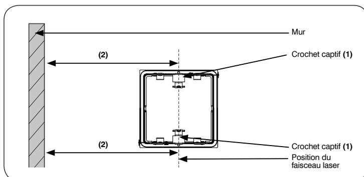
3. Verrouiller les crochets captifs et vérifier que les crochets appliquent une pression contre le plafond et y maintiennent solidement le support de garniture.
