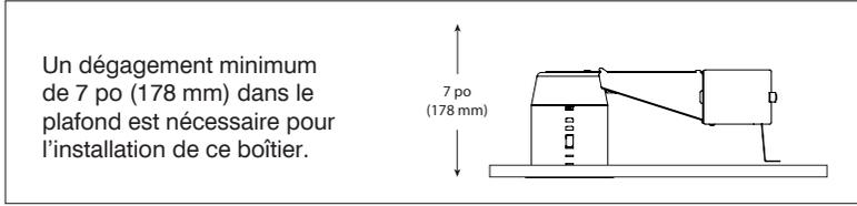
**Note :** Les crochets captifs sont préinstallés pour un plafond jusqu'à 1/2 po (13 mm) d'épaisseur. Possibilité d'ajustement jusqu'à un maximum de 1-1/4 po (32 mm) d'épaisseur de plafond.
