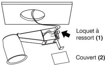
5. Faire le branchement des fils conformément aux diagrammes ci-dessous. Fermer la boîte de raccordement en replaçant le couvercle (2).
