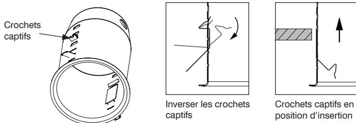
7. Insérer le boîtier dans l'ouverture du plafond.
