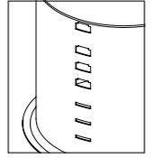
Trous d'ajustement pour le crochet captif.
