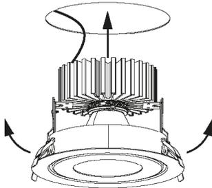
4. L'ajustement par incrément (2,5 degrés chacun) des garnitures orientables s'effectue simplement en pressant les rebords du centre dans l'angle désiré.
