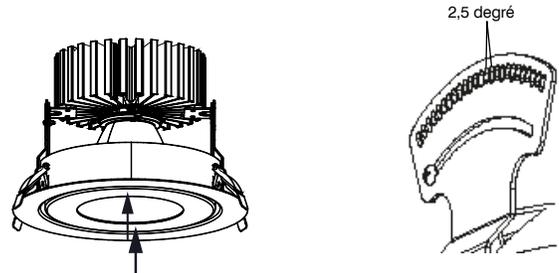
5. Il est possible de bloquer le mécanisme avant l'installation à l'aide de la vis de blocage.
